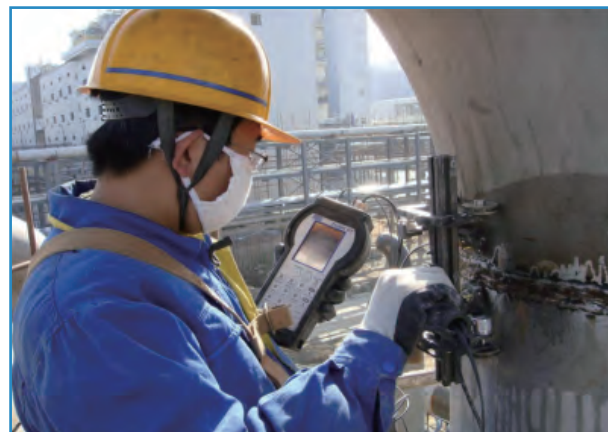
容器焊缝手动TOFD检测
