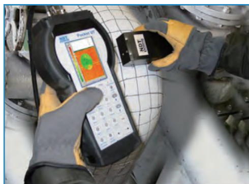
手动管道弯头腐蚀检测
