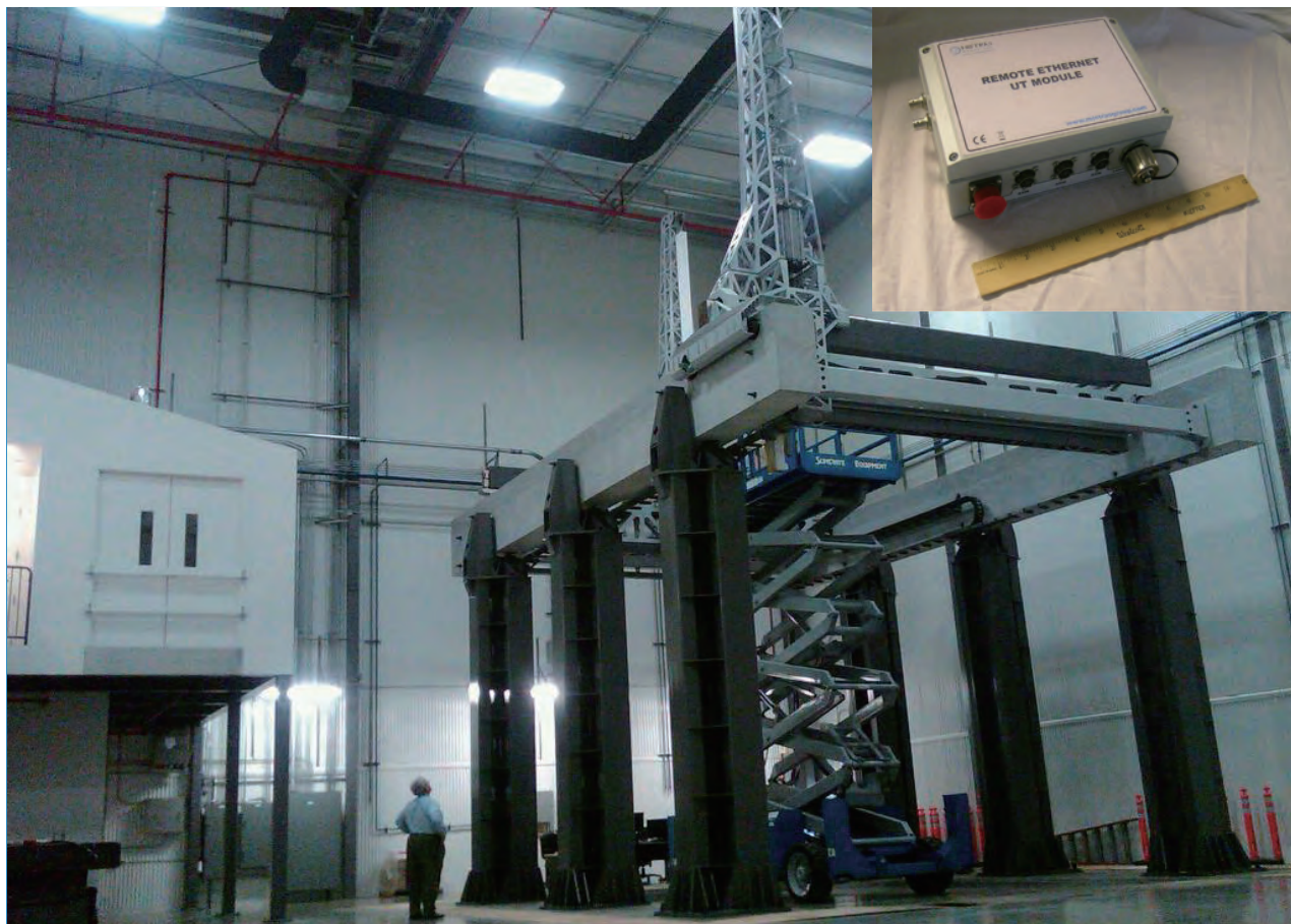
超微型超声/运动控制/计算机一体化远程集成模块
