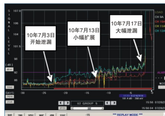
30天再热管泄漏趋势记录
