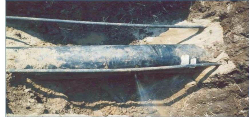
由声发射检测发现的地下管道泄漏
