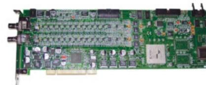
两通道声发射卡PCI-2
