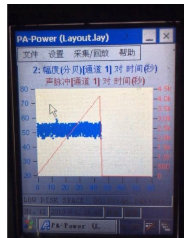
图 3.信号幅度在 45-60dB, 幅值很高
