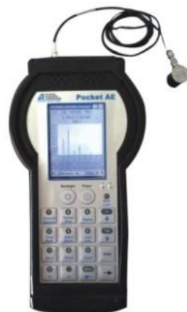
P-AE 接超声传感器
