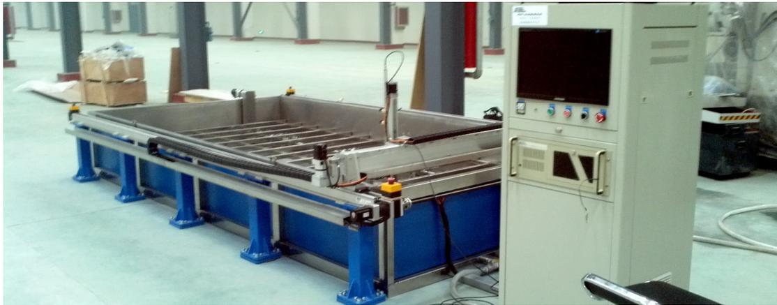
UPK-T4000 系统及 UTwin 软件，可针对有色金属的检测特征、靶材行业检测的要求进行了定制，在通用超声 C 扫描功能的基础上，综合了各种特征扫描、焊合率评估等特色功能，能全方位对原材料、靶材质量进行评定。
