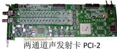
两通道声发射卡 PCI-2
