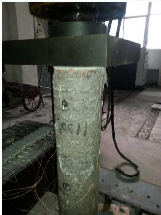
图 4 单轴加载时钢筋混凝土试块的三维定位
