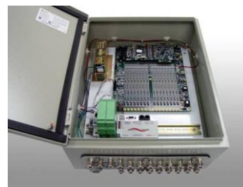
全天候岩石、隧道、矿山在线监测主机 SHII
