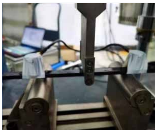
碳纤维板三点弯曲声发射监测
